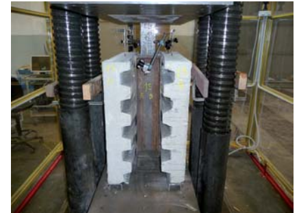
Push out test en el laboratorio de la facultad de Ingeniería de la Universidad de Padua y en el laboratorio Tecnaria.
