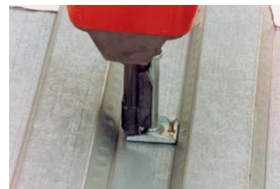
Figura 6 Clavadora: detalle del sensor magnético
