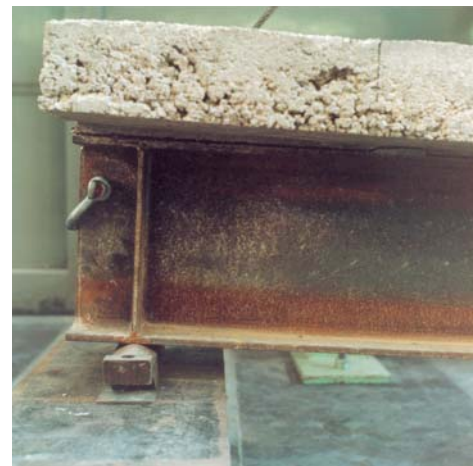
Fig. 32 Muestra t1, losa todavía entera después del agotamiento de la viga de acero. 32
