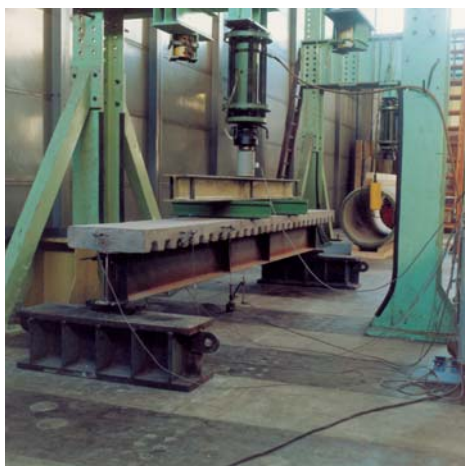
Fig. 33 Muestra T2 instrumentado para la prueba. 33
